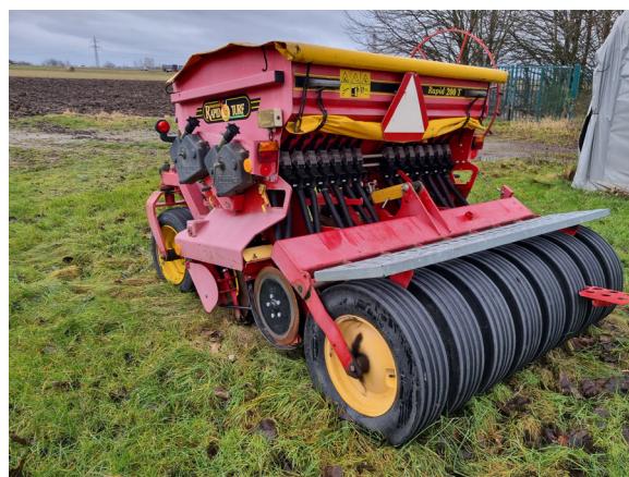
Bild 2. Under 2022 och 2023 såddes försöken med en Väderstad Rapid Turf. Maskinen har ett radavstånd på 6,25 cm, men genom att stänga såbillar kunde vårkornet även sås med det mer normala radavståndet på 12,5 cm och det dubbla på 25 cm med samma såmaskin.
