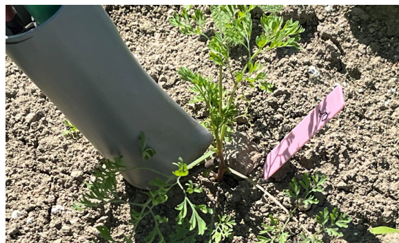
Utrustningen som användes i fältförsöken är en fältprototyp designad för punktbehandling av ogräs. En elektrod sticks ner i jorden medan den andra placeras mot ogräset.
