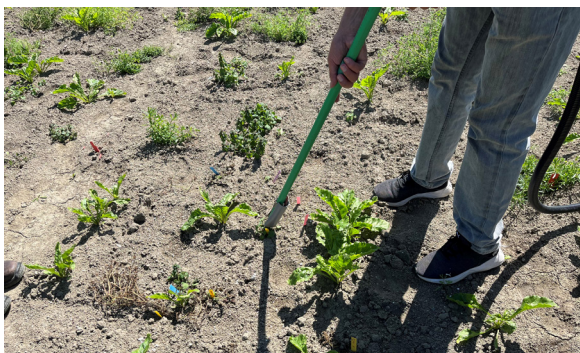
Utrustningen som användes i fältförsöken är en fältprototyp designad för punktbehandling av ogräs. En elektrod sticks ner i jorden medan den andra placeras mot ogräset.
