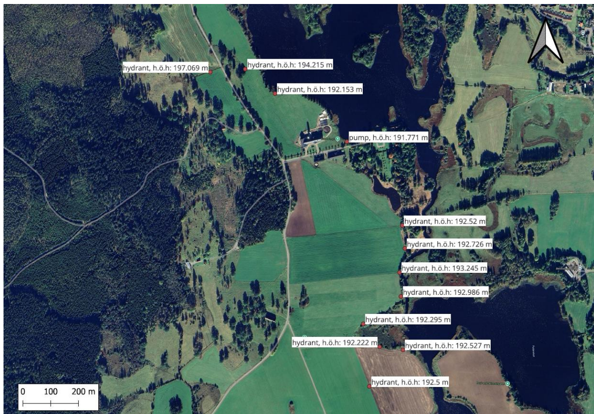
Figur 3. Översiktsskarta över pumpplatsen samt de 11 hydranternas.
