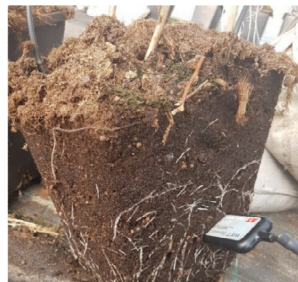
Fuktsensor av FDR-typ med kombinerad ledningstalsmätning. Den här mätaren mäter i en total substratvolym om ca 250 cm 3 .
