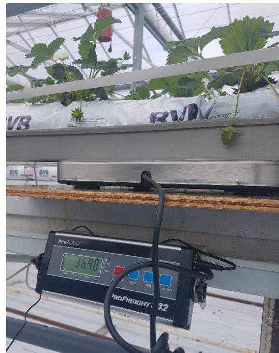
Bild 15. En våg som läses av manuellt vid samma tidpunkt varje dag.
