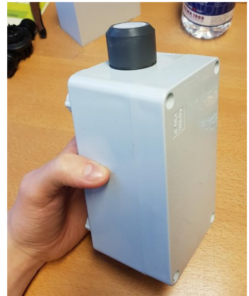
Bild 10. Ljuskvoten till solintegratorn registreras genom instrålningsgivaren med vit topp ovanpå lådan.
