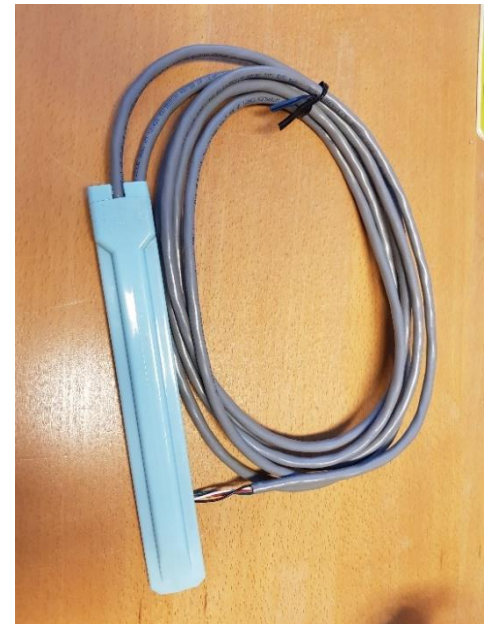
Bild 11. Fuktighetssensor från GroPoint av FDR-typ. En fördel är att denna sensor mäter över en rätt stor volym tack vare dess längd, ca 20 cm.
