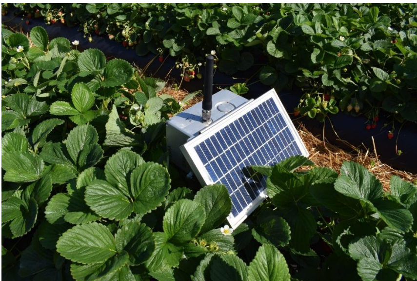
Bild 2. Trådlös fjärrstation från HORTAU som är kopplad till en markfuktssensor. I praktisk odling med nöjd odlare. Studiebesök i Kanada 2016
