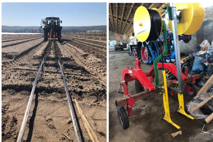
Figur. Nedläggare kopplas på maskin. Droppslangen matas genom rör ner i marken. Foto: J.Lundblad.
