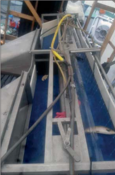
Sortering av fisk i sorteringsbord med valsar. Foto: Daniel Bergfors
