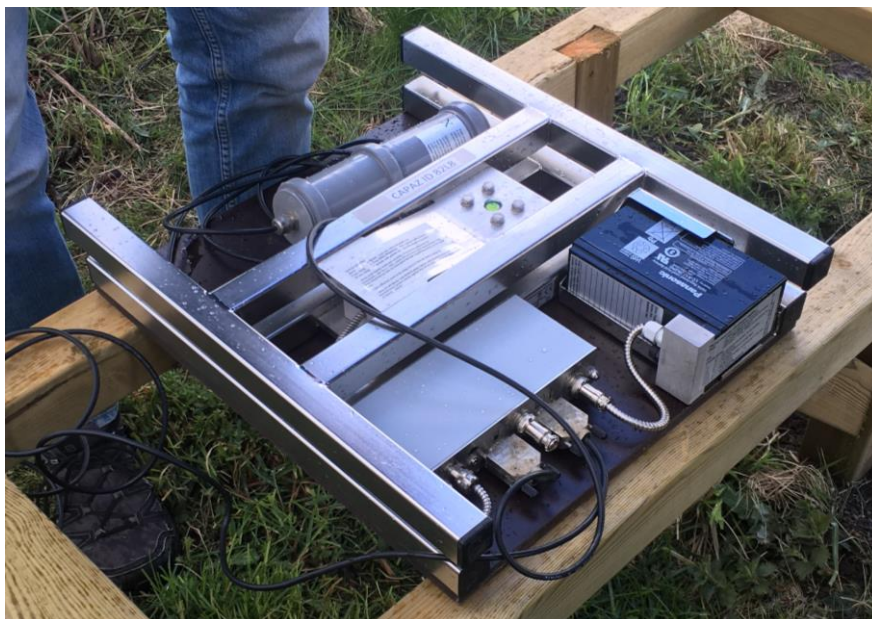
Bild 6. Kupvåg som bisamhällets uppstaplingslådor ställ på för att kontinuerligt vägas.
