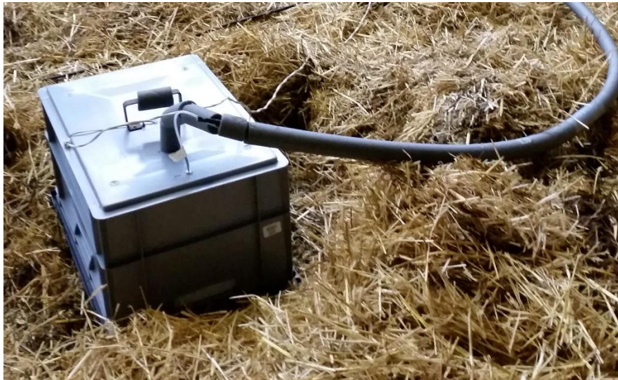
Figur 3. Mäthuv för mätning av lustgas och metan (Foto: Anna Jansson).
