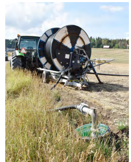
Bevattningsanläggningen flyttas en gång per dygn och kopplas in i en annan hydrant.
