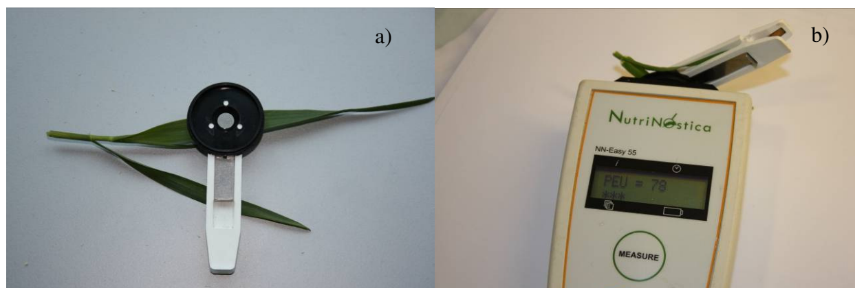
Figur 2. a) Innan manganskanning mörkeranpassades bladen med hjälp av ett clips. b) Mätning med manganskanner. Foto: Eva Stoltz
