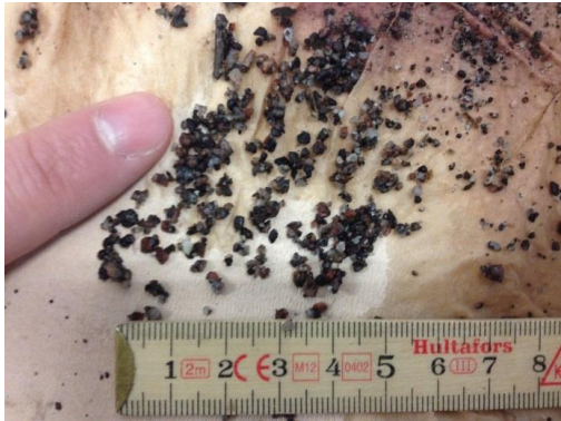
Figur 4. Exempel på grus som påträffats i rötresten som lämnat en rötchammare i projektet.
