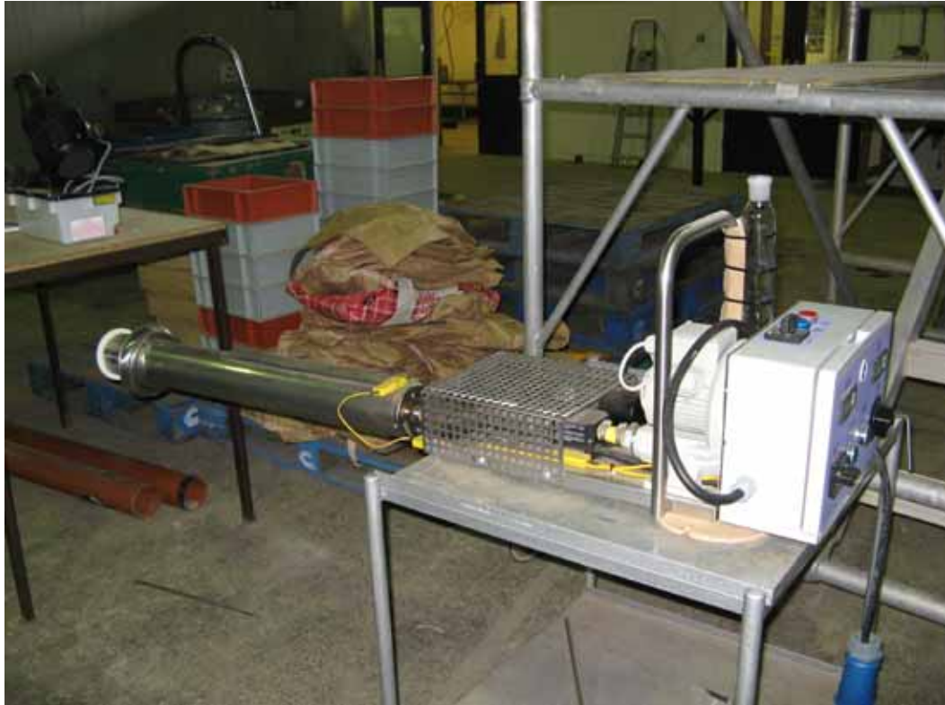
Figur 8. Etylengenerator som konverterar etanol ( C_2H_5OH ) via en katalysator till etylengas ( C_2H_4 ) och vatten ( H_2O ) (Foto Rolf Lindholm).
